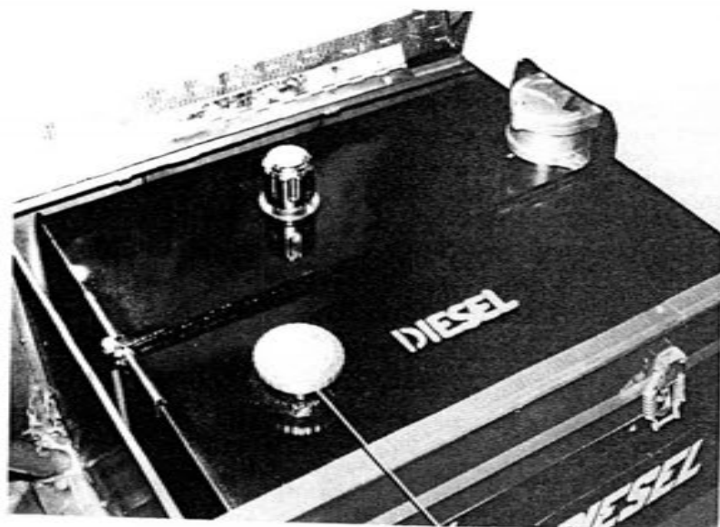
Polttoainesäiliö Bränsletank Fuel tank
