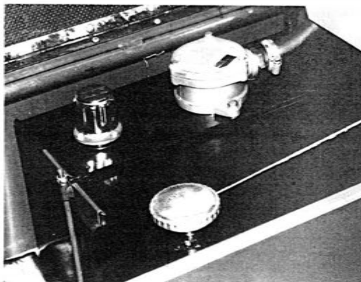
Polttoainesäiliö Bränsletank Fuel tank
